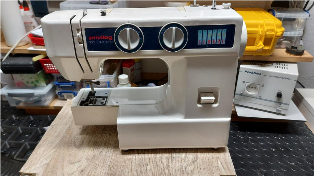
Nadel, Nähfuß, Stichplatte, Spulenkapself und Spule entfernen.
