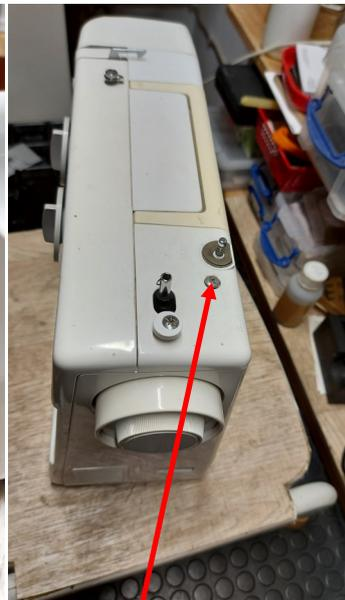
Schraube entfernen und Spuler abneh-
