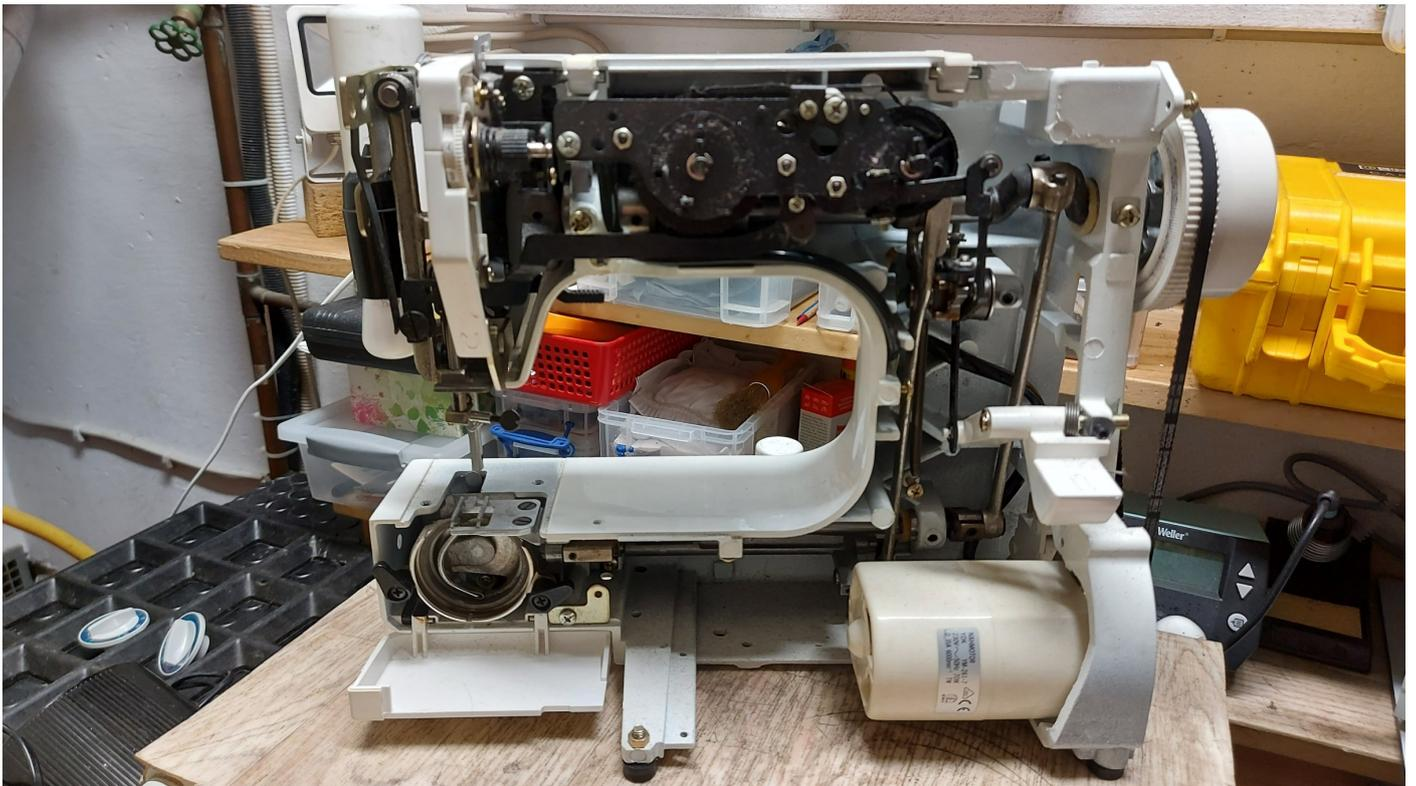
Vordere Abdeckung abnehmen. Nähmaschine reinigen, ölen
