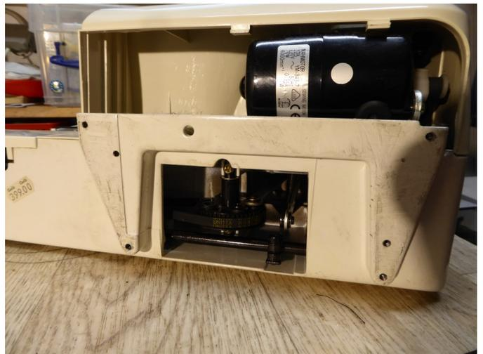
Schrauben entfernen und Abdeckung abnehmen.
