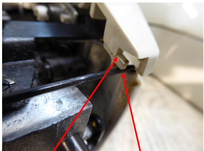
Gehäuse von der Querstange aushängen.
