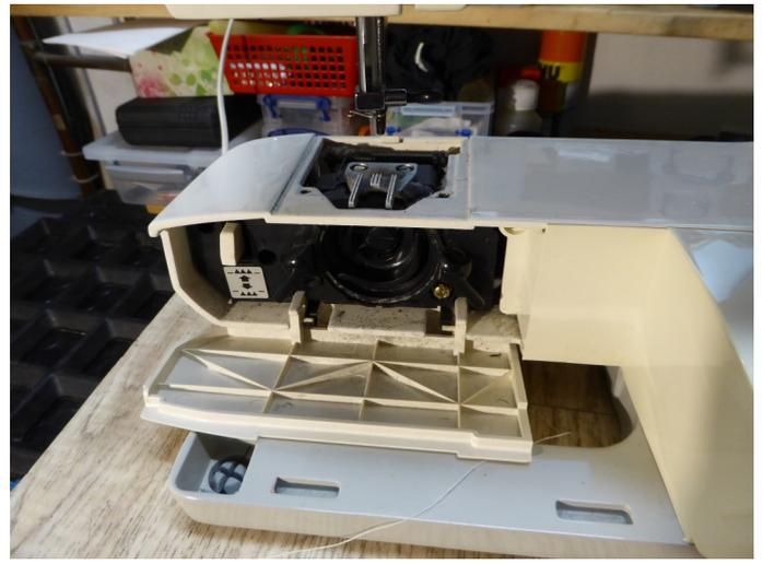
Anschietisch, Stichplatte, Nadel, Nähfuß, Spulenkapsel, Spule, Greifer ausbauen.
