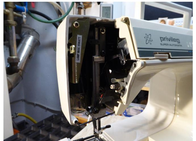
Schraube entfernen, Abdeckung abnehmen.
