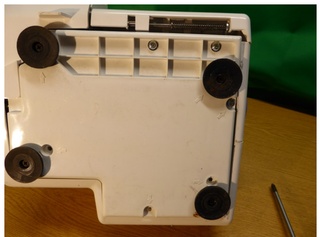
Bodenplatte mit Frontabdeckung abnehmen
