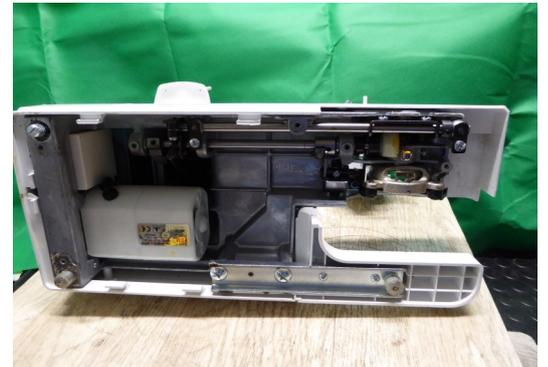
Schraube entfernen und Greiferabdeckung abnehmen.
