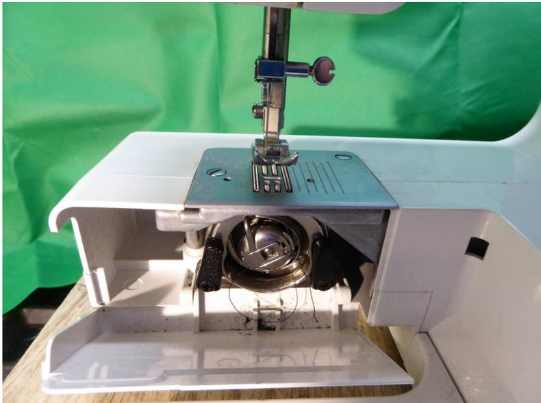
Nadel, Nähfuß, Stichplatte, Spulenkapsel, Spule, Greifer ausbauen.
