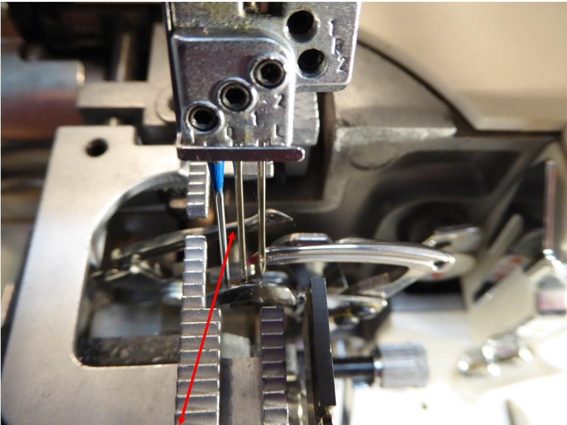
Linker Überwendlich-Greifer hat bei diesem Programm 03 keine Funktion.
