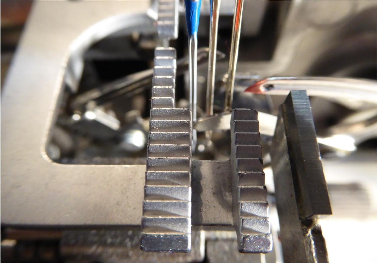
Ist die Endstellung vom Doppelkettenstich- bzw. Coverstich-Greifer erreicht, verschiebt er sich axial nach hinten.
