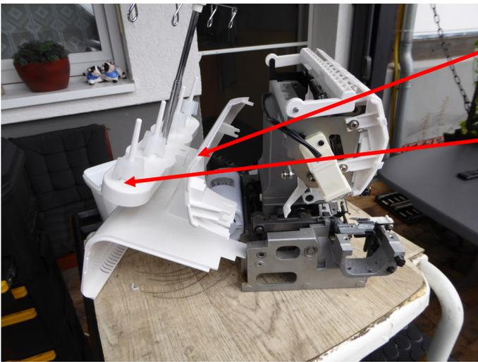
Rückwand entfernen, mit oder ohne Fadenrollenhalter.
