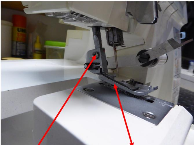
Schraube lösen, Nähfuß abnehmen. Nähfuß i.O.
