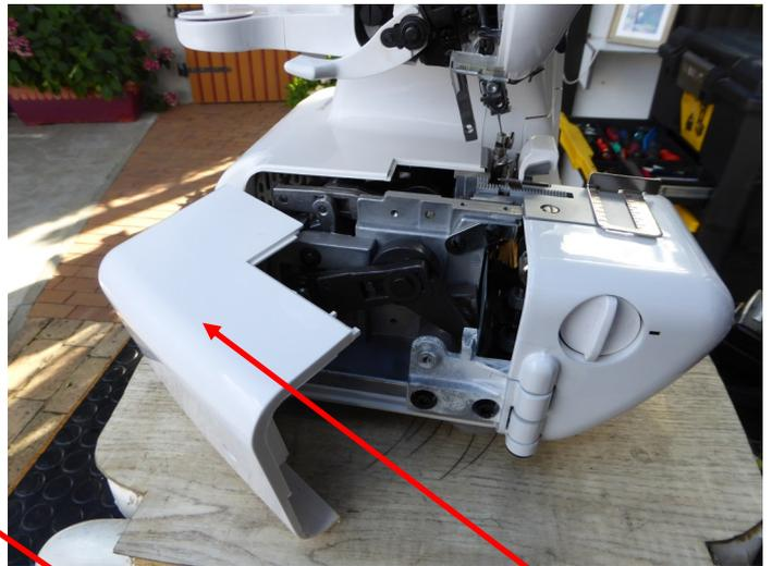
Schraube entfernen Abdeckung abnehmen
