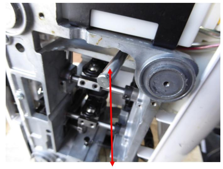
Sprengring und Unterlegscheibe entfernen Fadenbaumstange
