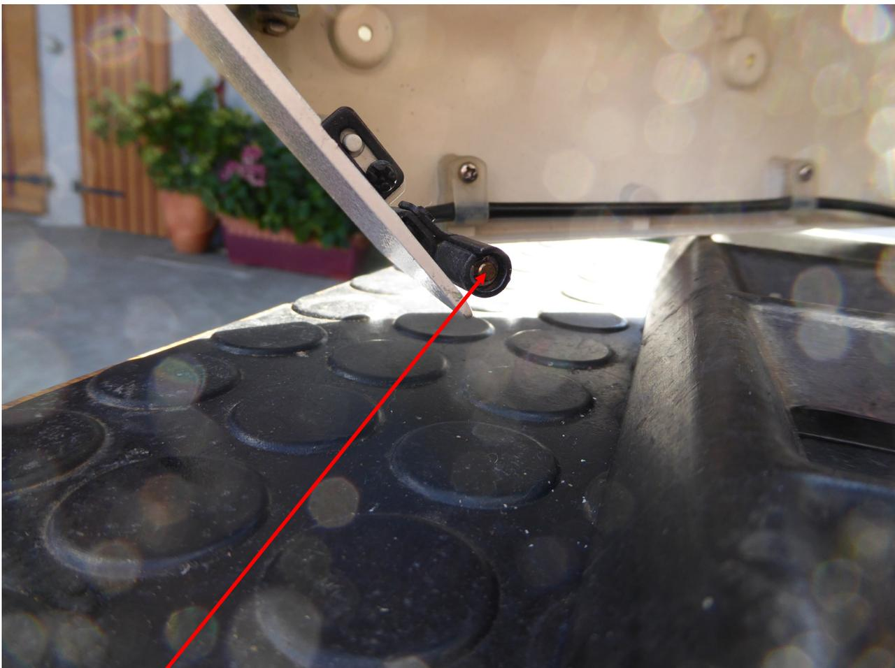
Sicherheitsschalter, verhindert das Anlaufen der Overlock bei aufgeklappten Seitenteil.
