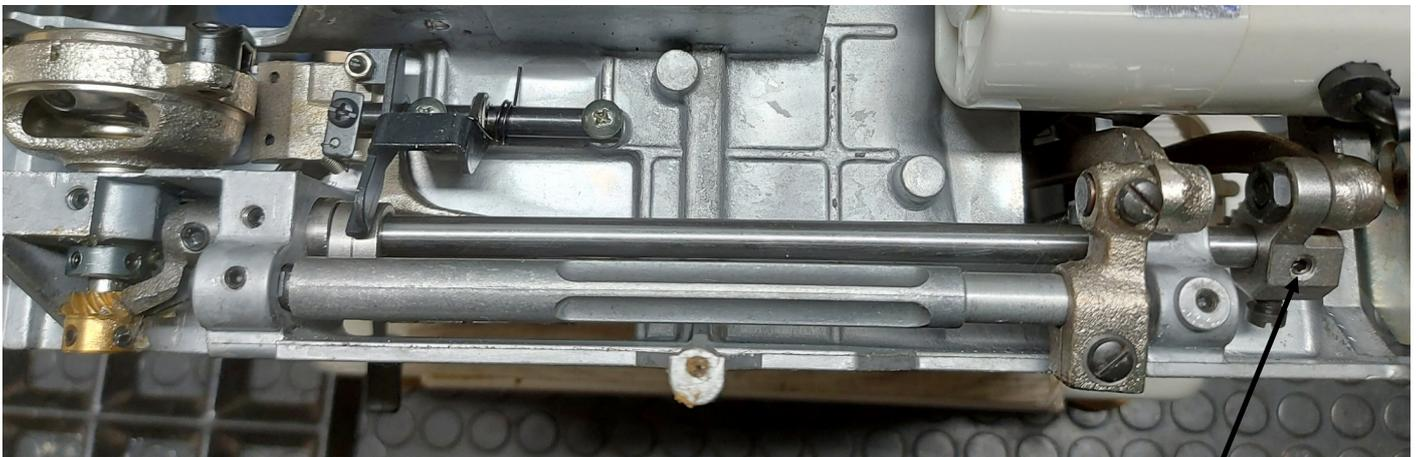
Oszillierender Greifer Nadelstange unten Stellung der Zahnräder Antriebsstange
