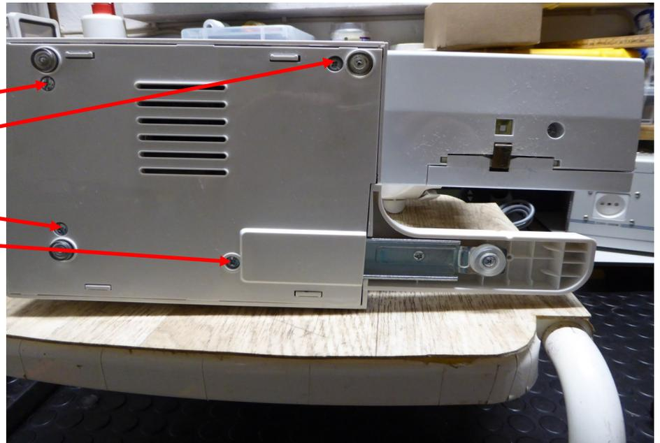
Schraube von der Abdeckung entfernen.
