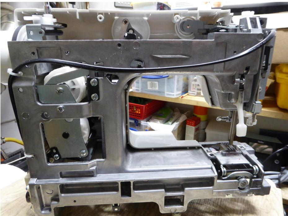
Jetzt kann man alle bewegliche Teile säubern und ölen bzw. Fäden aus den Antrieben entfernen. Nähmaschine in umgekehrter Reihenfolge wieder zusam-
