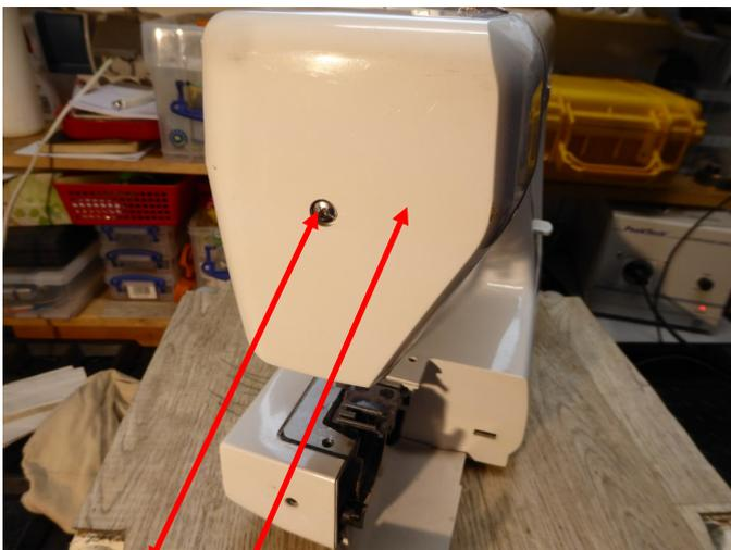
Schraube entfernen und Abdeckung abnehmen.
