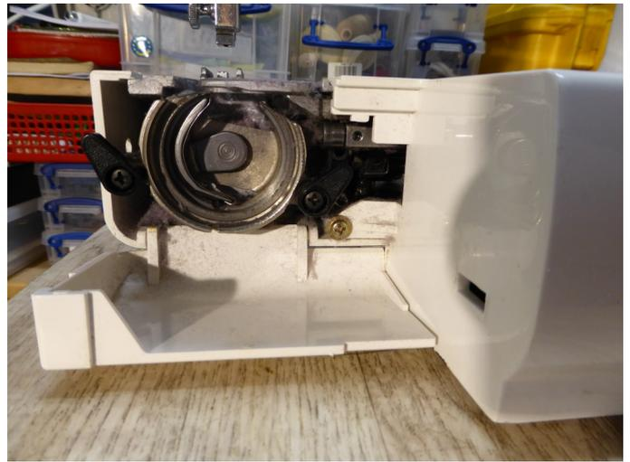
Anschietisch, Nadel, Nähfuß, Stichplatte, Spulenkapsel, Spule, Greifer entfernen.
