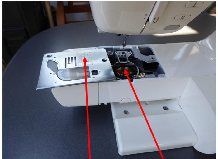
Anschietisch abnehmen, Nadel, Nähfuß Stichplatte, Spule und Spulenkapsel entfernen.
