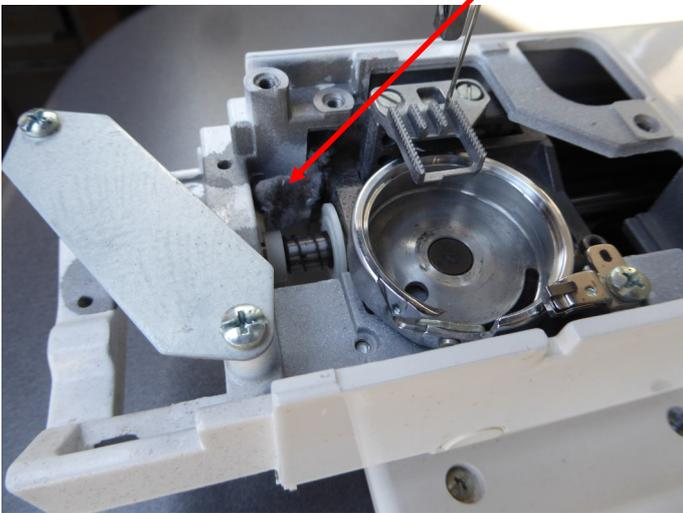
Schraube entfernen, Abdeckung entfernen.
