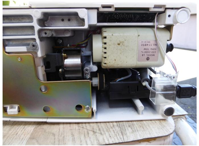
Schrauben entfernen und Abdeckung abnehmen
