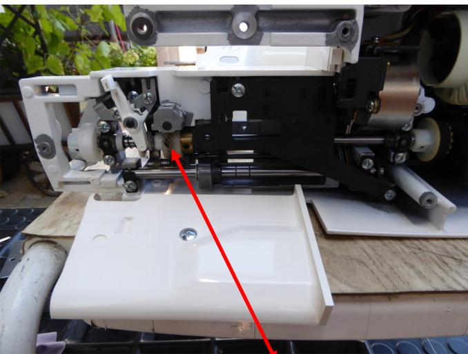
Verschmutztes Zahnrad, Zähne reinigen.
