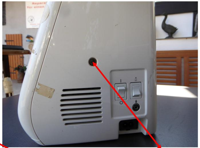
Abdeckung entfernen, Schraube entfernen,
