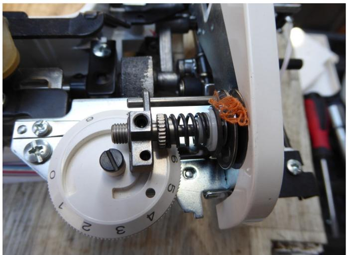
Fadenreste zwischen den Oberfadenspannscheiben entfernen.
