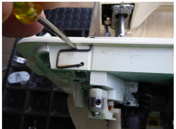
Sperre für Spulenabdeckung nach unten ziehen und Spulenabdeckung abziehen.
