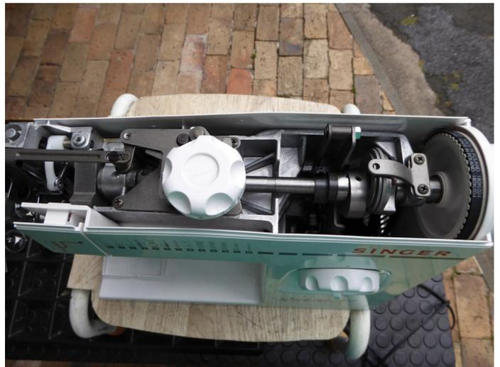
Schrauben entfernen    Abdeckung abheben
