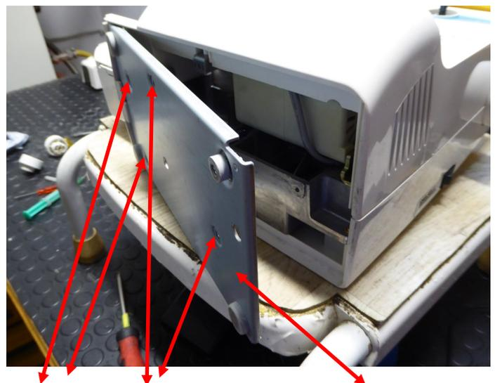
Schrauben entfernen Bodenplatte abnehmen.
