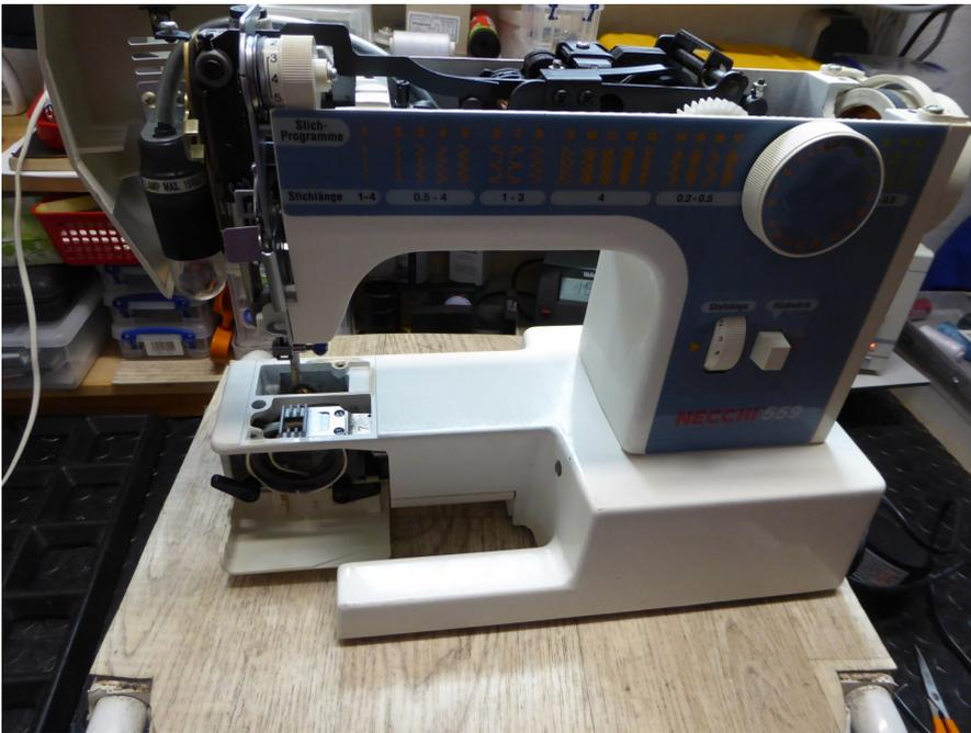
Nadel, Nähfuß Stichplatte, Spulenkapsel mit Spule, Greifer
