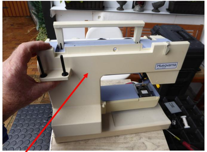
Abdeckung nach oben schieben und entfernen.
