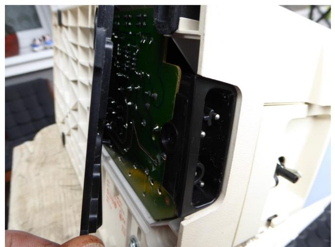
Hinter der Abdeckung ist die Stromversorgung. Dafür die gesamte Bodenplatte abschrauben.
