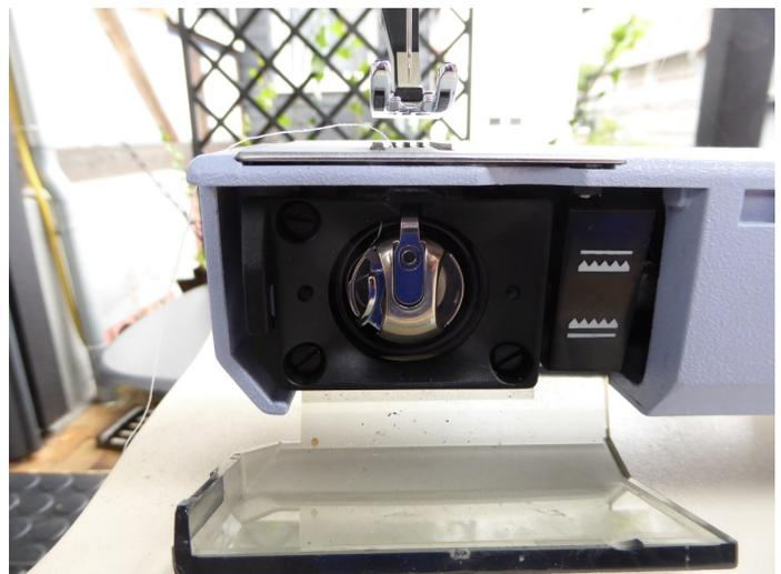
Spulenkapsel mit Spule entfernen.
