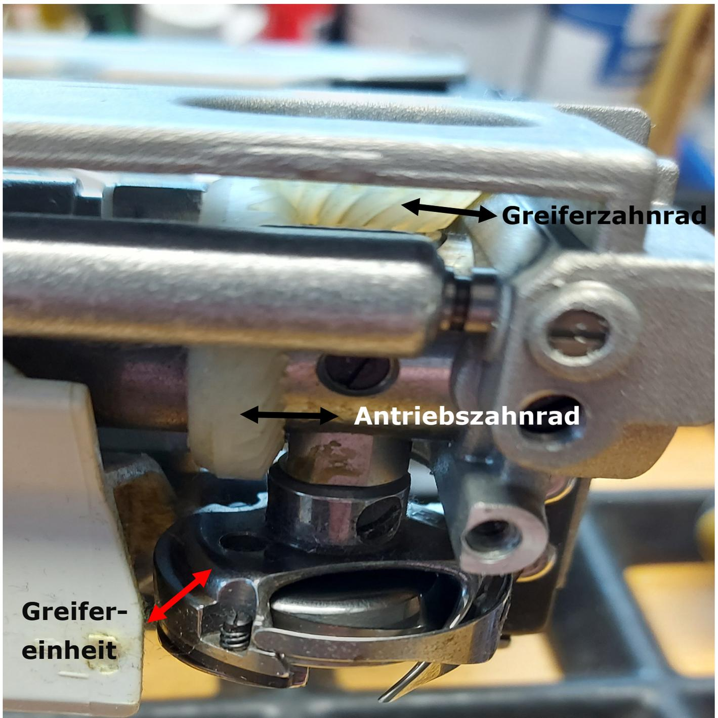
Durch lösen der Madenschrauben wird die Greifereinheit ausgebaut. Dadurch entspannt sich das Greiferzahnrad. Beim Einbau der Greifereinheit muss das Greiferzahnrad arretiert werden.
