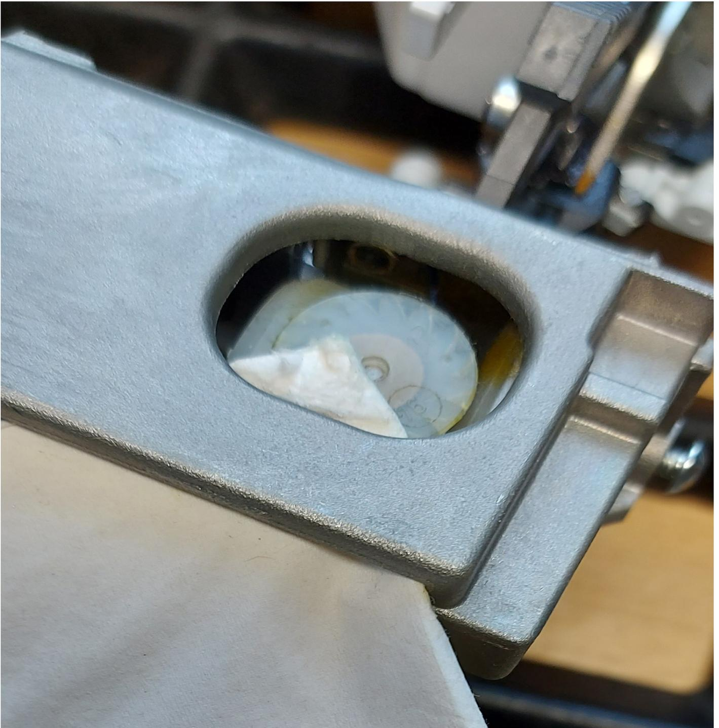
Greiferzahnrad mit einem Papiertaschentuch arretieren. Dadurch liegt das Greiferzahnrad direkt an das Antriebszahnrad an ohne großes Spiel. Greiferzahnrad nicht mit dem Papiertaschentuch einpressen, weil dann die Nähmaschine schwergängig läuft. Jetzt die Greifeinheit einbauen und einstellen. Danach das Papiertaschentuch entfernen.
