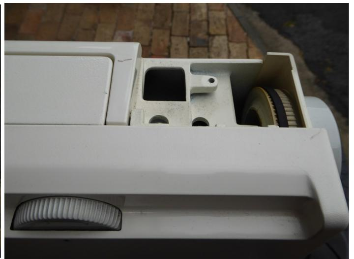
Schraube entfernen, Spuler mit Garnrollenhalter entfernen.
