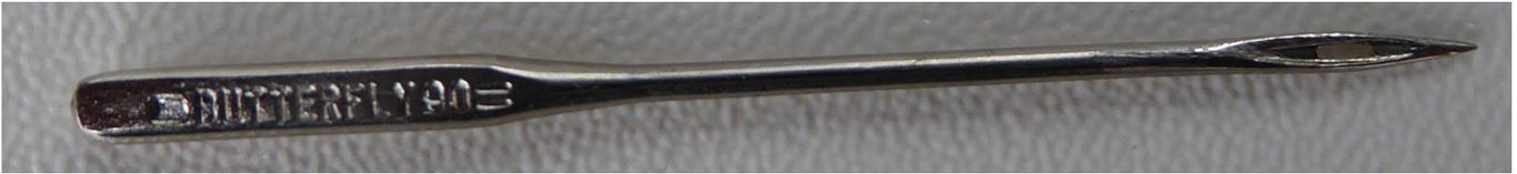
Diese Nadel ist eine Fehlkonstruktion. Der Greifer kann den Oberfaden nicht umschlingen, sondern sticht ihn durch, Der Faden reißt.
