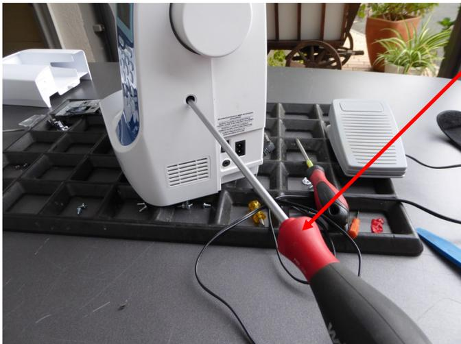
Innenliegende Kreuzschlitzschraube nur lösen
