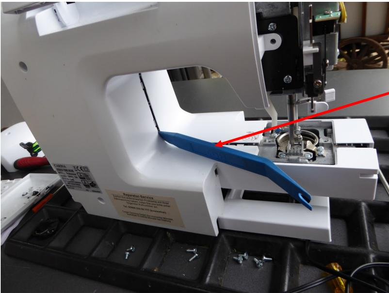
Klickverschlüsse aufdrücken und Gehäuse öffnen.
