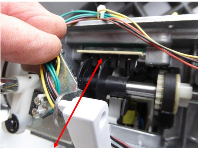
Steuereinheit für die Geschwindigkeitskontrolle
