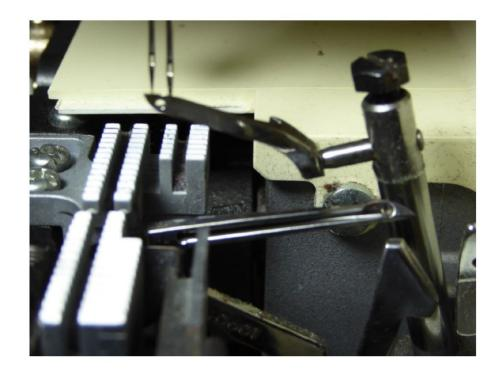
Wenn der Untergreifer im rechten Totpunkt ist, dann steht der Obergreifer vor beiden Nadel wie im Bild. Die Nadelspitzen befinden sich in gleicher Höhe mit dem Obergreifer.
