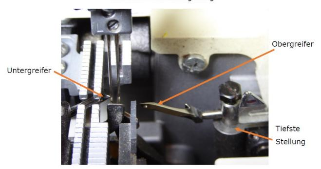
Wenn der Obergreifer in der tiefsten Stellung ist, steht der Untergreifer direkt hinter der linken Nadel.
