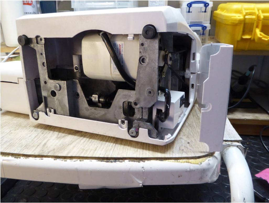
Bodenplatte und seitliche Abdeckung entfernen.
