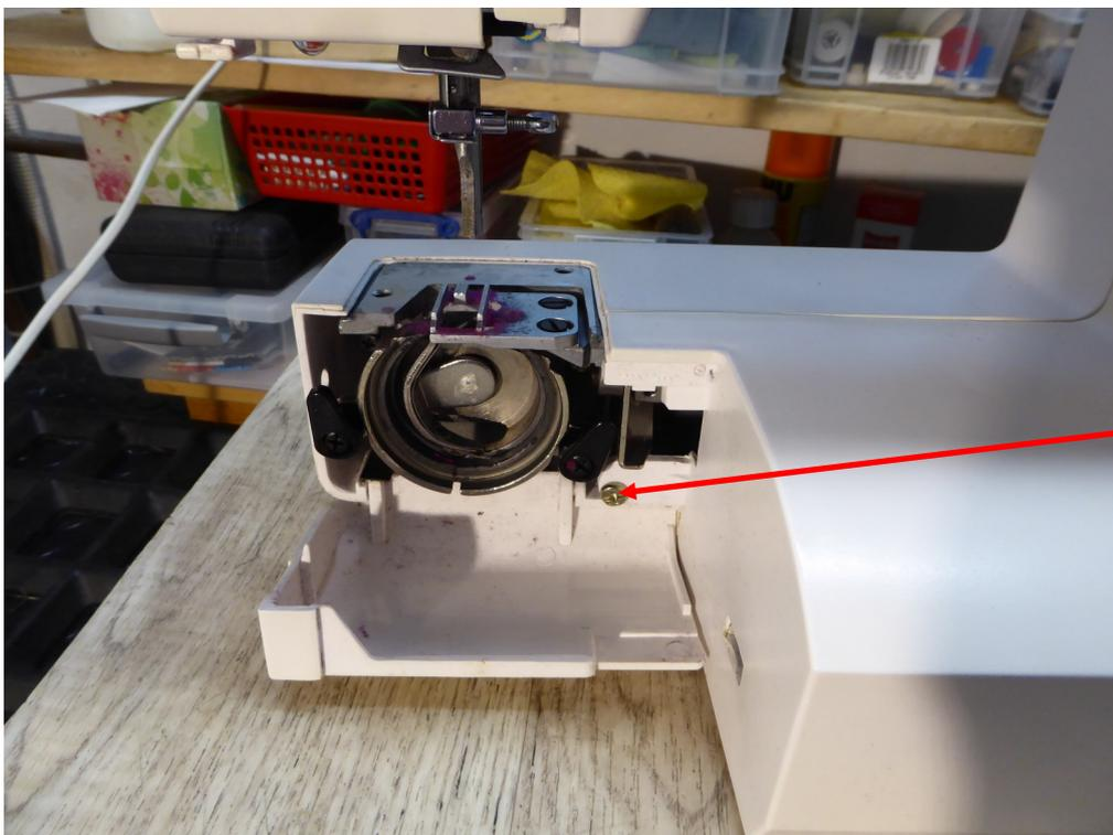
Schraube entfernen für das Frontteil.
